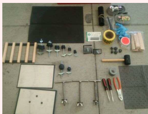
漏洩止め用の資機材(例)
