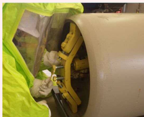
塩素ガス容器への漏洩止具取付
