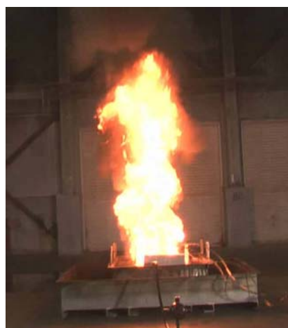
ボイルオーバー発生時センタータンク （火炎高さ 6m）
