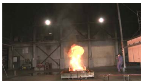
センタータンク ボイルオーバー群発
