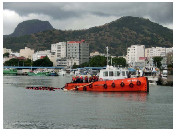
海上浮遊油の回収訓練
